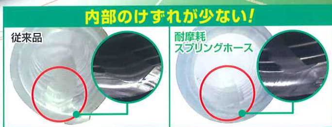
試験方法:ヤスリ(上目58)を1秒=1回の速度で前後1000回、75mm移動させて試料ホース内面を摩耗させる。
